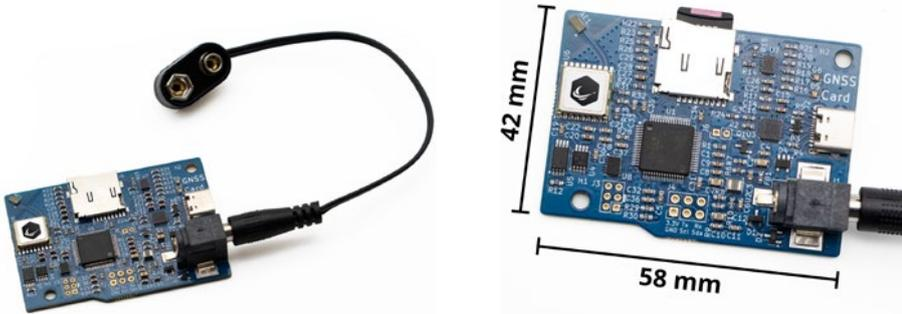
Der batteriebetriebene Datenlogger STRATOfmini misst und speichert verschiedene Daten wie GPS Koordinaten, Höhe und Temperatur, ist mit seinen 13g extrem leicht und hat die Größe einer Streichholzschachtel.
